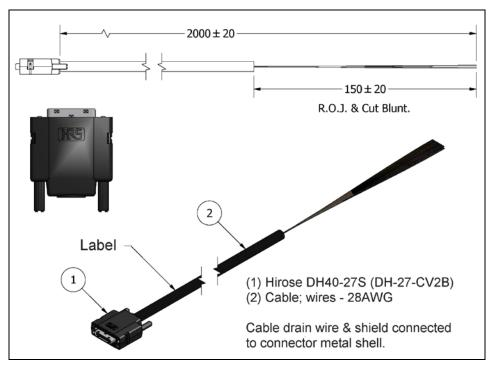
Figure 32: DH60-27P Cable No. OR-YXCC-27BE2M1 Detail
